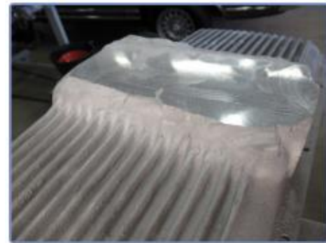
图 3 - 机加工前进行油底壳冷喷涂
