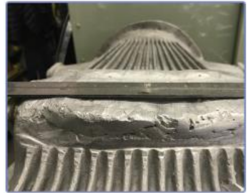
图 2 - 油底壳内外可见裂纹造成的泄漏和缺乏美观
