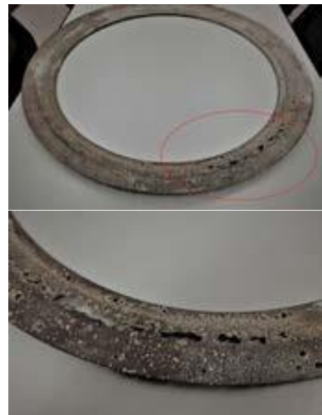
图2b与c 被重度腐蚀已穿孔的炮塔安装环
